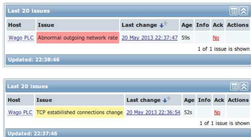
Figura 15: Triggers disparadas pelo tráfego anormal gerado pela emissão de tráfego modbus não autorizado e extração de dados modbus
